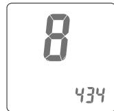
2. 完成测量后，你的血糖值结果将会显示于屏幕上，测量结果会以mmol/L(毫摩尔)的单位呈现。
