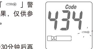
」警示符号会闪烁，仍可以进行测试但可能会求得不正确的测试结果，仅供参考。请在操作温度范围内重新做测试 (10~40°C 或 50~104°F)。
